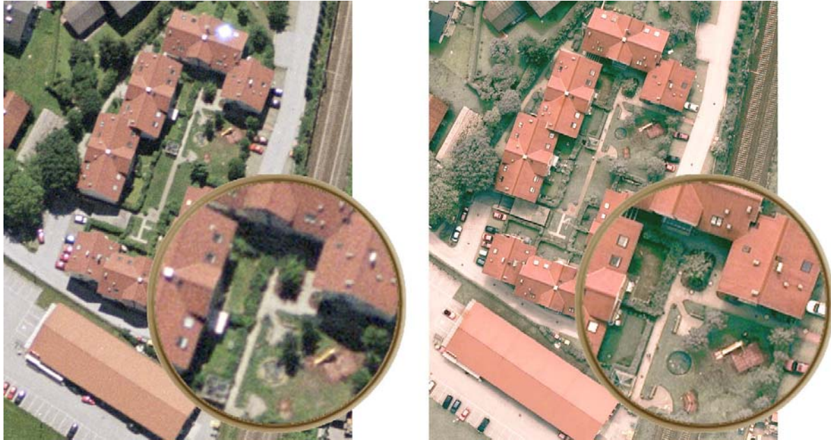
Abbildung 2: Analoge und digitale Luftbildaufnahmen im direkten Vergleich. Die analoge Aufnahme vom 6. Juli 2002 auf AGFA X100 Farbnegativfilm zeigt wesentlich weniger Details als die digitale Aufnahme vom 9. August 2002. Die Detailvergrößerung zeigt in beiden Fällen einen Bildkreis mit einem Durchmesser von 210 Pixel oder 31 Meter in 2-facher Vergrößerung.
