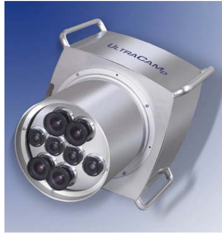
Abbildung 7: Ansicht der Sensoreinheit von unten. Im Sensor befinden sich 8 Objektive, davon dienen 4 für die panchromatische Aufnahme, 4 für die Aufnahme der 4 Farbkkanäle rot, grün, blau und infrarot. Jedes Objektiv hat dasselbe Gesichtsfeld. In der Bildebene sind die Flächenarrays angebracht. Der panchromatische Konus mit 4 CCDs dient als „Masterkonus“ zur Festlegung des Bildkoordinatensystems.
